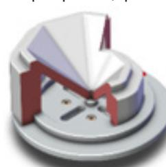
CT-Fix-Bauteile werden mit Hilfe der Adapterplatte in der Mitte des Messtrichters positioniert. Sie verfügt über einen Zentrierstift ( $\varnothing$  5mm) und 4 Langlöcher (M6), mit denen sie exakt auf der Messplatte zentriert werden kann.
