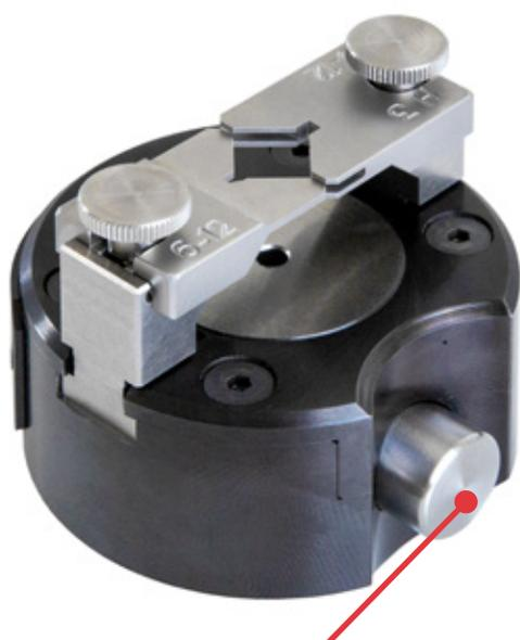
Dual-Fix mit manueller Betätigung sowie pneumatischer Betätigung möglich
